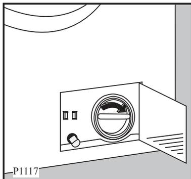
7. Die Grobkörperfalle einsetzen und den Deckel im Uhrzeigersinn wieder fest verschrauben.
